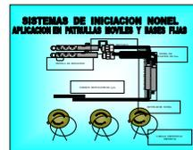
**SISTEMA DE DEFENSA NO ELÉCTRICO, CONFORMADO POR CARGAS DEFENSIVAS DIRIGIDAS, DETONADORES NO ELÉCTRICOS, CORDÓN DETONANTE Y PISTOLAS PERCUTORAS; PERMITIENDO ARMAR CUATRO LÍNEAS DE DEFENSA CON DOBLE SISTEMA DE INICIACIÓN.**
