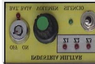
SISTEMA DE ALERTA ELECTRÓNICO, CONFORMADO POR UNA UNIDAD DE CONTROL CON TRES ZONAS DE SENSADO, LAS CUALES SE INTEGRAN MEDIANTE CABLE DUPLEX 2X18 A QUINCE (15) UNIDADES SENSORAS UBICADAS EN EL TERRENO, COMUNICADAS UNAS CON OTRAS MEDIANTE ALAMBRE DE TROPIEZO Y ALIMENTADO MEDIANTE CELDA SOLAR.
